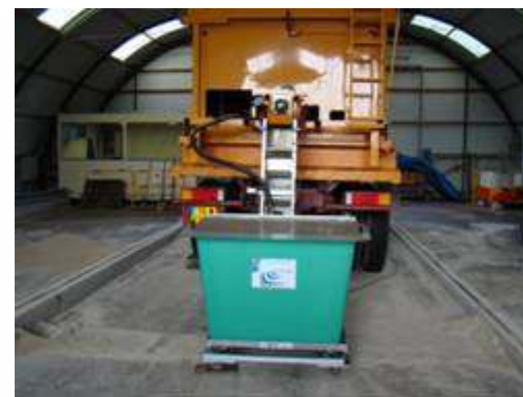
Figure 2. Matériel pour essais statiques (ODEMIE)
