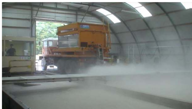
Figure 5. Banc d'essai de répartition transversale des répanduses (EPIR)
